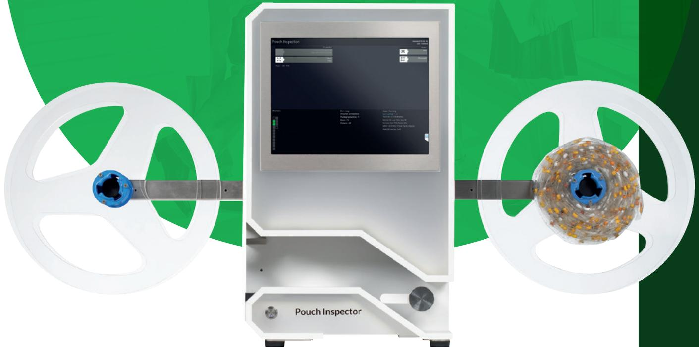
La solution indépendante de contrôle des productions de sachets/doses produites par votre automate de PDA. La reconnaissance de forme et de couleur est effectuée par deux caméras numériques qui s'appuient sur une base de données intelligente qui s'enrichit au fur et à mesure de l'utilisation
